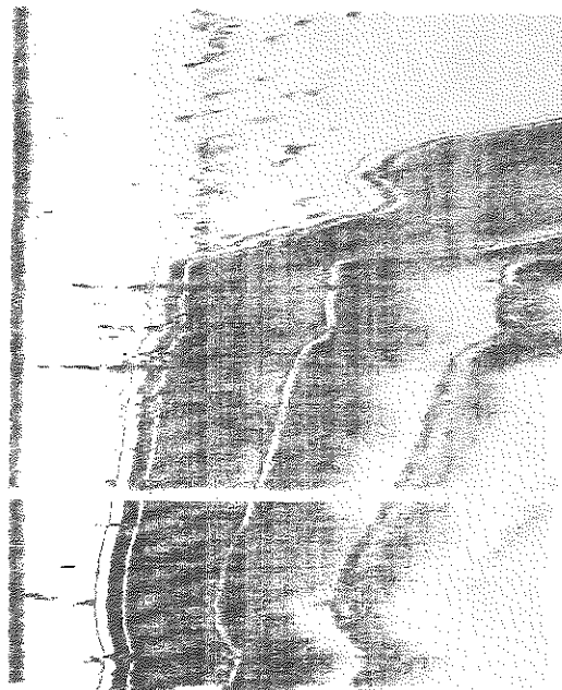
Fig. 10 Ekolodning i Vojmsjön utanför Dajkanvik den 10 september 1974 kl. 9. Som vanligt i ekobilder är höjdskalan och längdskalans olika, hela sträckan ca 1 km lång, 10 m i höjddled = 12 mm.
