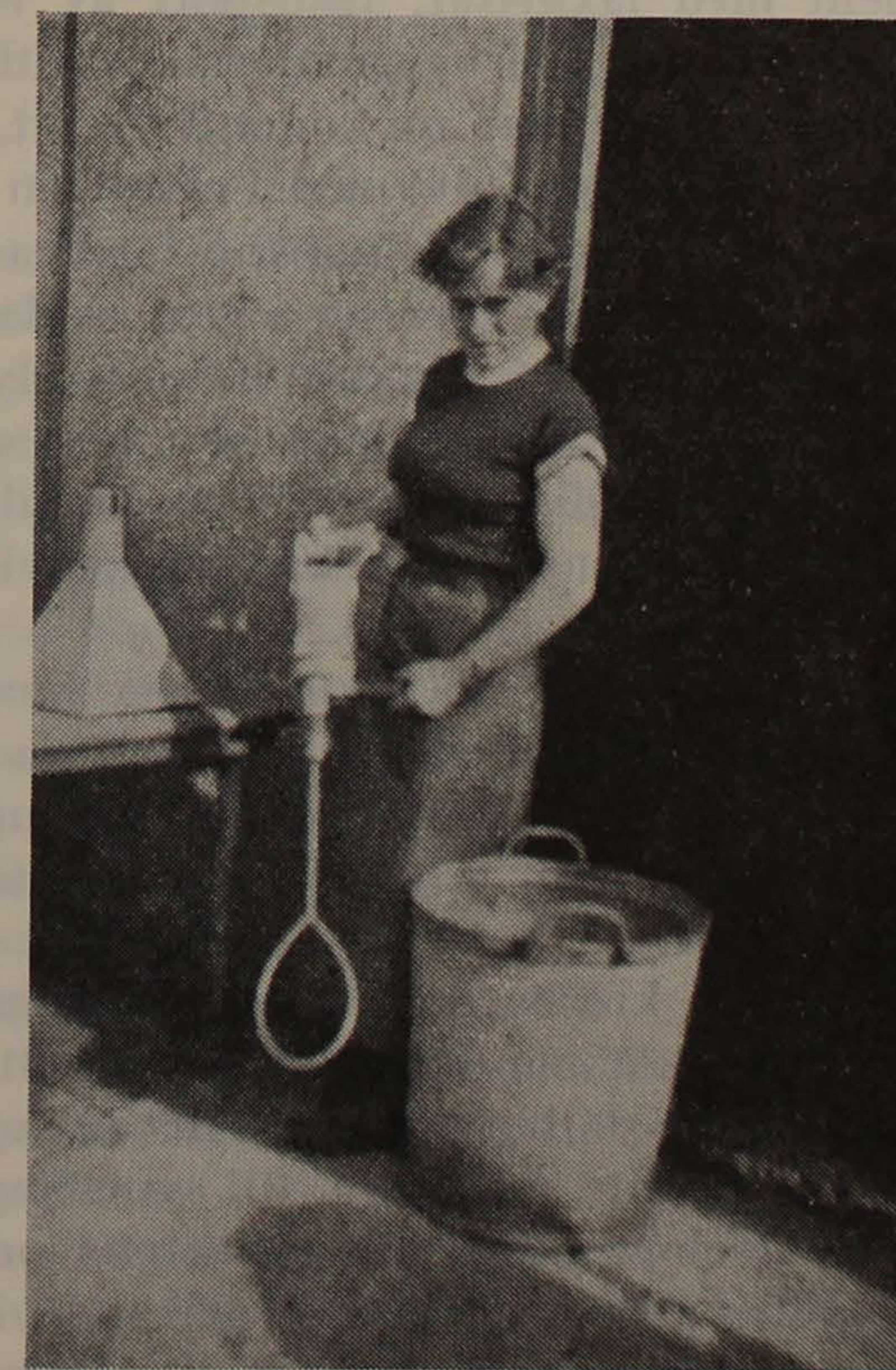
Fodret blandas med en el-borrmaskin med påmonterad »pisker».
